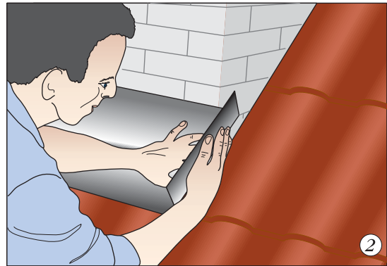
Вдавить лист в угол, формируя его по трубе и профилю кровли, и загнуть края
